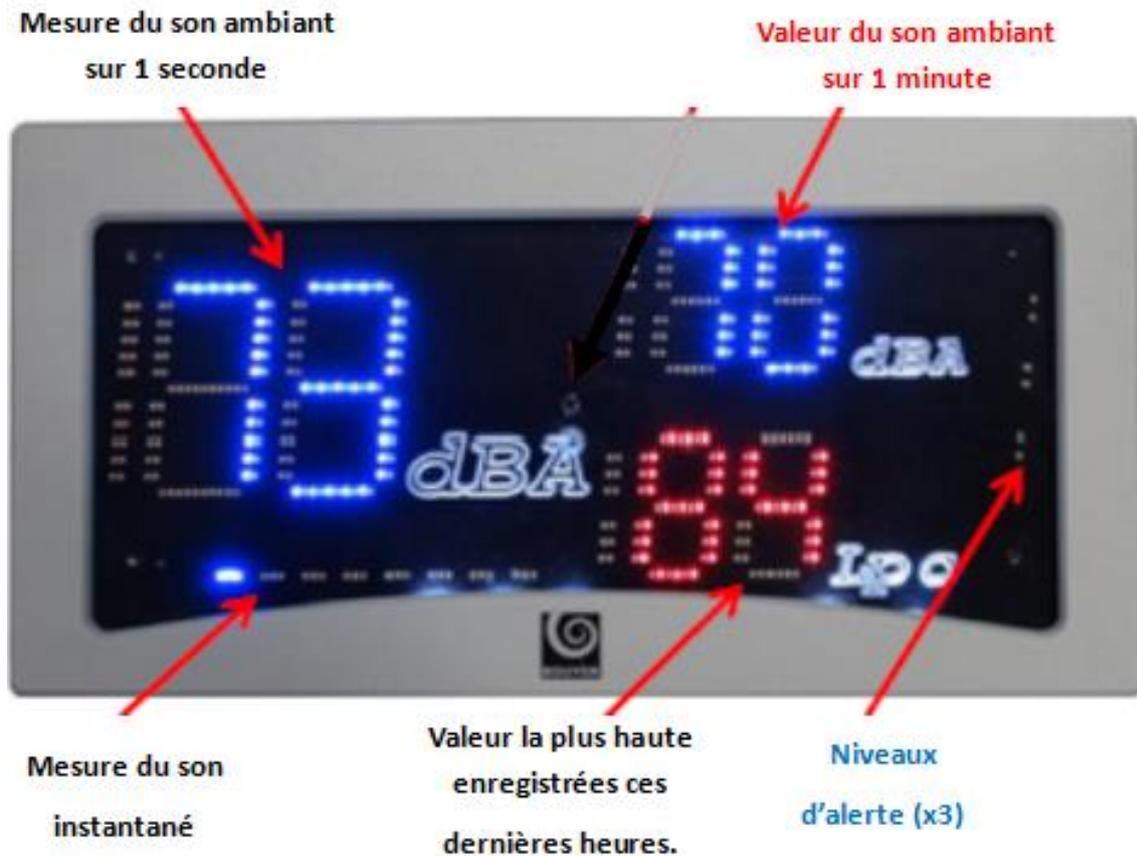
**Principe de fonctionnement:**
